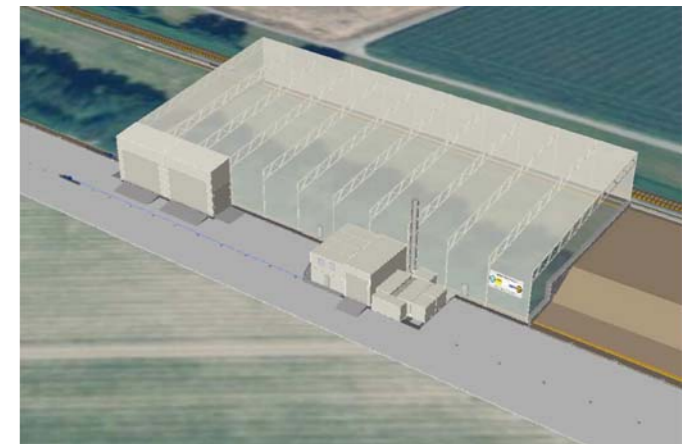
L'excavation des déchets se déroulera sous une halle étanche, placée sur des « guides », qui sera déplacée au fur et à mesure de l'avancement des travaux.
