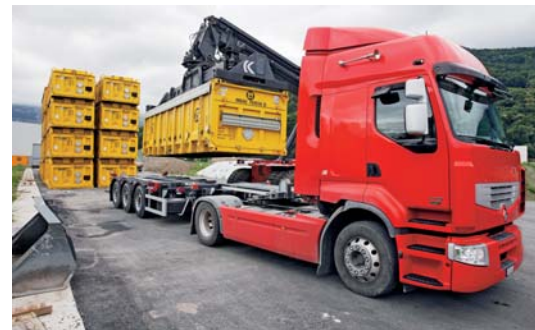
Chargement des containers sur des camions pour le transport jusqu'à la gare de Saint-Triphon.
